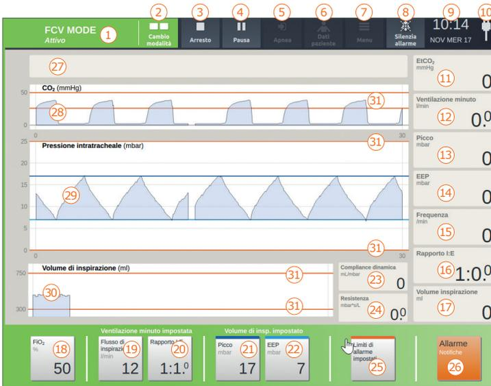
Figura 6.3 Aspetti dell'interfaccia utente in modalità FCV®
