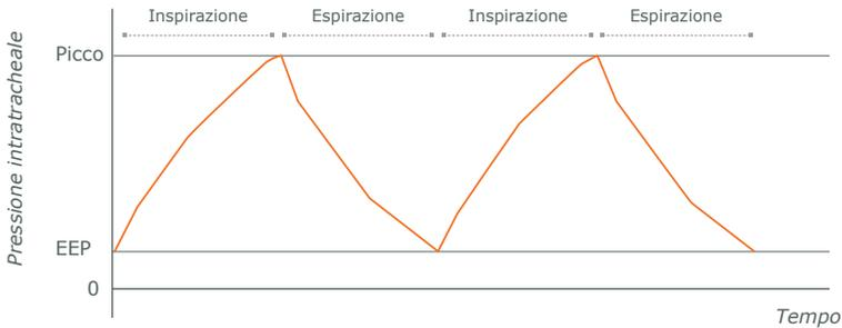
Figura 3.1 Profilo di pressione intratracheale della modalità FCV®
